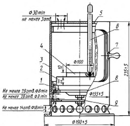
1 — электроподогревающий элемент (мощность 650 В · А); 2 — нагревательная пластина; 3 — металлический корпус; 4 — диск; 5 — верхняя крышка; 6 — термометр; 7 — подвижная стеклянная дверца; 8 — накладка; 9 — нижняя крышка
