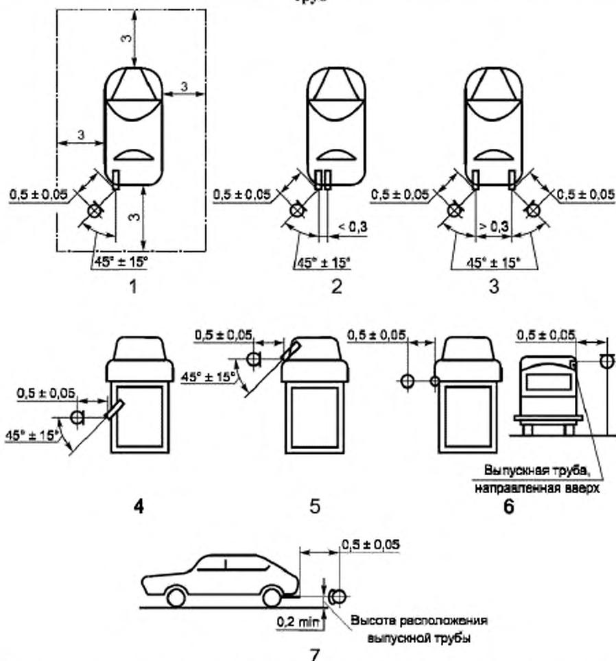
1–5 — установка микрофонов относительно выпускной трубы в горизонтальной плоскости; 6 — установка микрофонов относительно вертикально расположенной выпускной трубы; 7 — установка микрофонов относительно выпускной трубы в вертикальной плоскости
