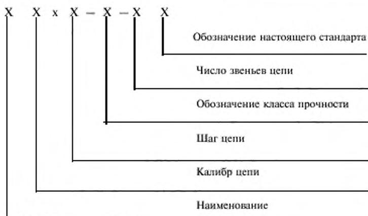
4.3.2 Пример условного обозначения грузоподъемной калиброванной высокопрочной цепи калибра 18 мм, с шагом 54 мм, с числом звеньев 245
