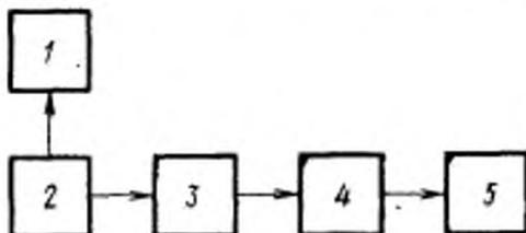
1 — вольтметр постоянного тока; 2 — источник постоянного тока; 3 — счетчик ионизирующего излучения; 4 — усилитель импульсов; 5 — осциллограф
