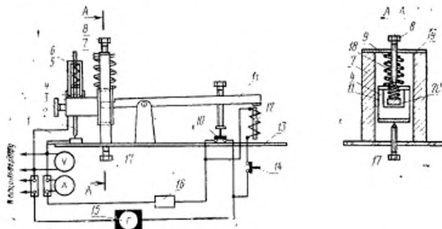
Электродержатель 4 движется в направляющих 7, укрепленных на панели 13 и соединенных сверху пластиной 19 с регулировочным винтом 8, ограничивающим подъем электрода 2, что обеспечивает необходимый зазор между электродом и образцом 1.
