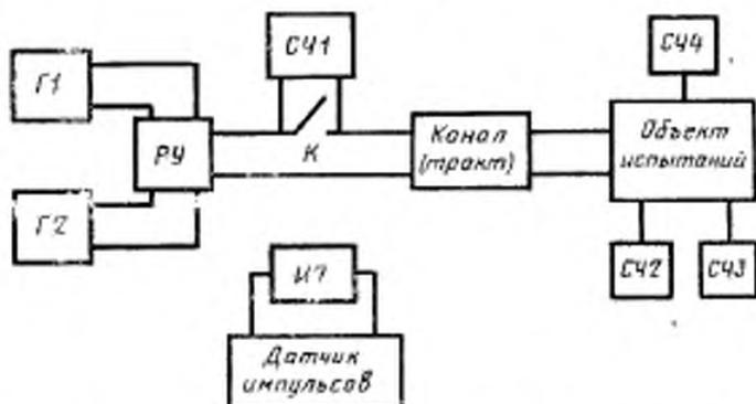
Г1, Г2—генераторы сигнала; РУ—развязывающее устройство; ИЭ—исполнительный элемент датчика импульсов; К—контакт исполнительного элемента; Сч1, Сч2, Сч3, Сч4—счетчики импульсов
