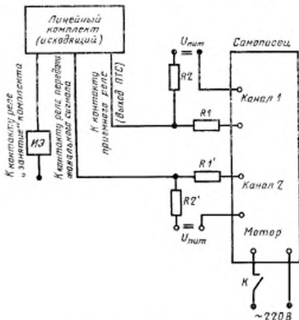
ИЭ — исполнительный элемент, К — контакт исполнительного элемента
