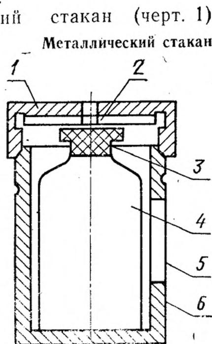
1 — навинчивающаяся крышка; 2 — шайба; 3 — резиновая пробка; 4 — пенициллиновая склянка; 5 — прорезь в металлическом стакане; 6 — корпус металлического стакана
