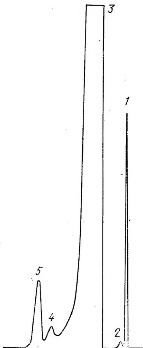
1 — воздух; 2 — 1,2-дихлортетрафторэтан; 3 — 1,1,2-трифтор-2,2-трихлорэтан; 4 — 1,1-дифтор-1,2,2-трихлорэтан; 5 — четыреххлористый углерод
