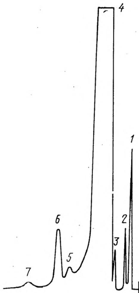
1 — воздух; 2 — 1,2-дихлортетрафторэтан; 3 — сумма 1,1,1-трифтор-2,2-дихлорэтана и 1,2,2-трифтор-1,2-дихлорэтана; 4 — 1,2,2-трифтортрихлорэтан; 5 — 1,1-дифтор-1,2,2-трихлорэтан; 6 — четыреххлористый углерод; 7 — 1,2-дифтортетрахлорэтан
