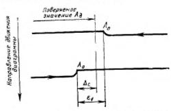
4.4. Основную погрешность приборов по записи времени (пл. 1.4; 15) следует определять при движущейся диаграммной в вормальных условиях применения с учетом следующих требований.
