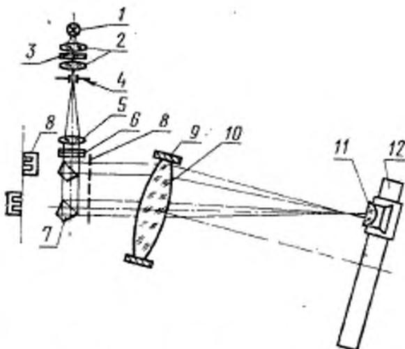
1 — источник света; 2 — конденсор; 3 — светофильтр; 4 — раздвижная щель; 5 — объектив коллиматора; 6 — конденсор наклона лучей; 7 — пентагональный отражатель; 8 — диафрагма с парой параллельных щелей; 9 — объективодержатель; 10 — испытуемый объектив; 11 — цилиндрический окуляр; 12 — поперечная линейка
