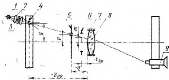
1 — источник света; 2 — конденсор; 3 — светофильтр; 4 — раздвижная щель на поперечной линейке; 5 — диафрагма с парой параллельных щелей; 6 — входной лучок испытуемой системы; 7 — объективодержатель; 8 — испытуемый объект; 9 — микроскоп на поперечной линейке
