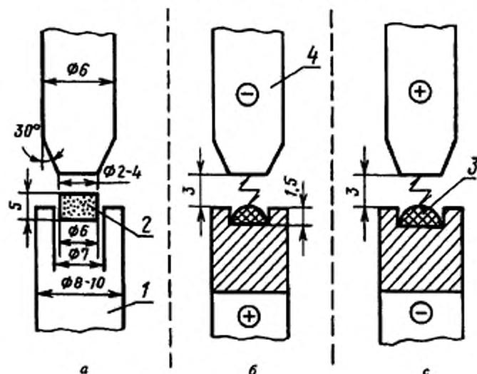
*a* — расположение и размеры электродов и брикета до экспонирования; *b* — съемка в анодном режиме; *в* — съемка в катодном режиме; 1 — графитовая подставка; 2 — брикет; 3 — расплав; 4 — подставной электрод
