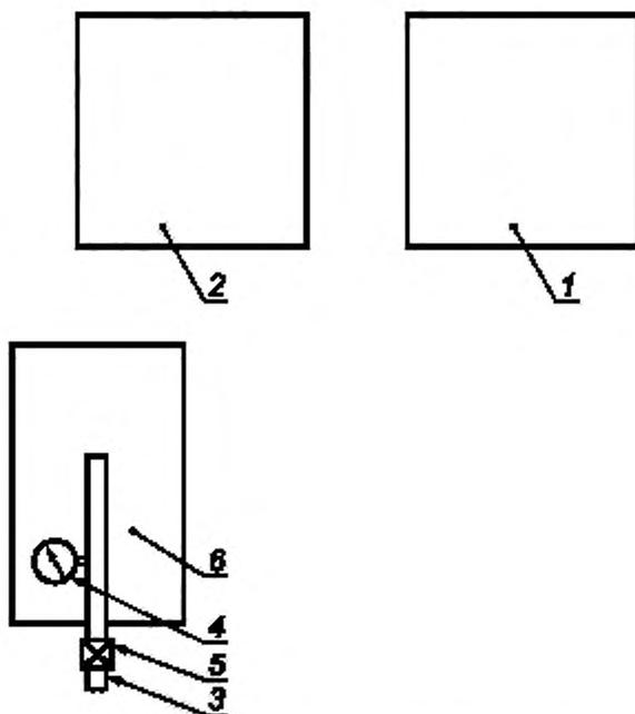
1 — сушильный шкаф; 2 — печь; 3 — трубопровод сжатого воздуха; 4 — манометр; 5 — вентиль; 6 — столик со стальной плитой
