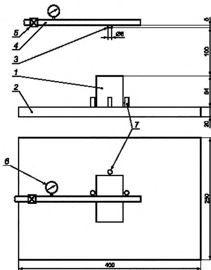
1 — образец; 2 — плита; 3 — сопло; 4 — трубопровод сжатого воздуха; 5 — вентиль; 6 — манометр; 7 — установочные штифты
