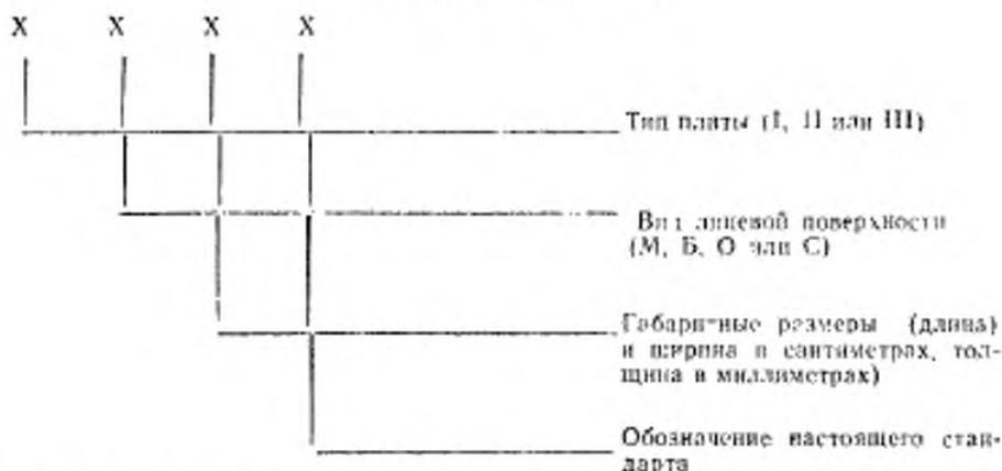
Пример условного обозначения декоративной плиты из природного камня I типа с мозаичной лицевой поверхностью, длиной и шириной 500 мм, толщиной 30 мм:
