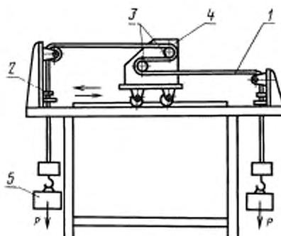
1 — испытуемый образец; 2 — ограничивающие зажимы; 3 — сменные ролики;
