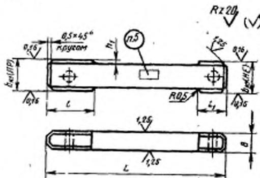
Примечание. Допускаются отверстия диаметром 2—3 мм (указаны штриховой линией) при обработке заготовок пакетом и для подвешивания.
