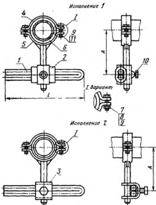
1—стержень; 2—ползунок; 3—скоба; 4—хомут; 5—хомут с хвостовиком; 6—прокладка по ГОСТ 24192—80; 7—болт М6×30.36.016 по ГОСТ 7798—70; 8—гайка М6.4.0.16 по ГОСТ 5915—70; 9—шайба 0.30.01 по ГОСТ 11371—78; 10—болт М8×16.36.016 по ГОСТ 7798—70; 11—болт М6×25.36.016 по ГОСТ 7798—70
