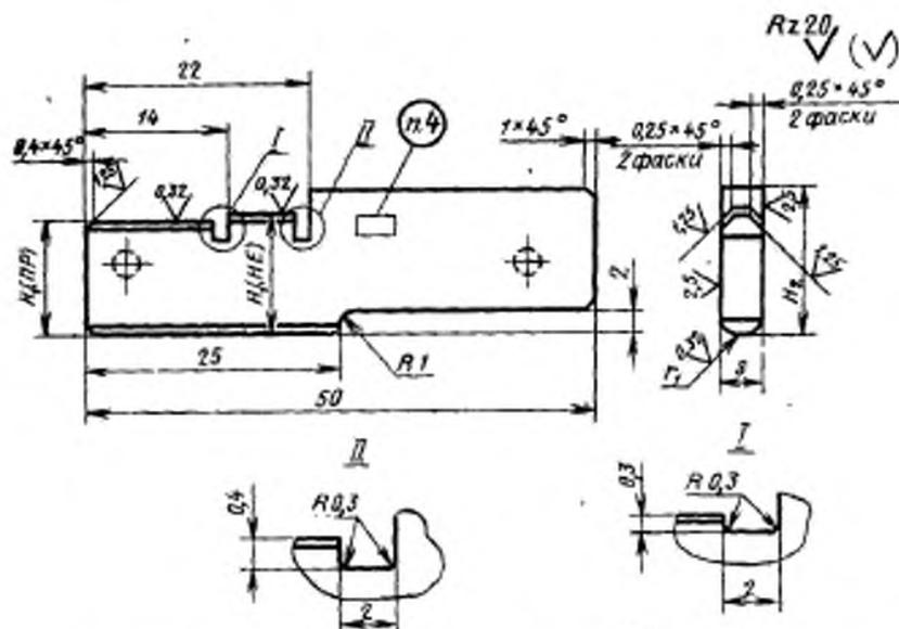
Примечание. Допускаются отверстия диаметром 2 мм (указаны штриховой линией) при обработке заготовок пакетом и для подвешивания.
