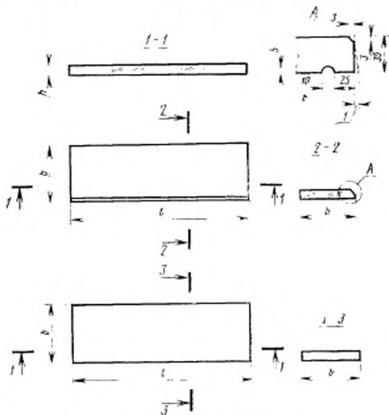
1—технологический уклон не более 2 мм
