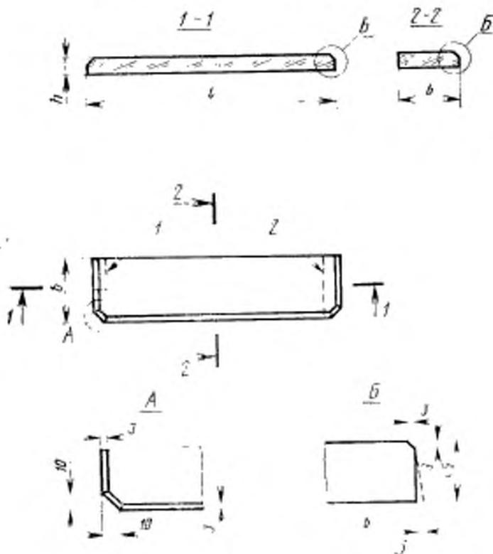
1—вырез 2—срез торца, 3—технологический уклон не более 3 мм
