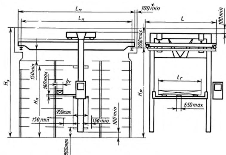
\* Допускается уменьшение до 50 мм в процессе эксплуатации крана-штабелера
