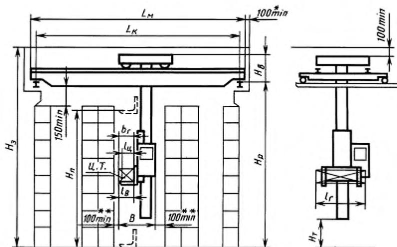
\* Допускается уменьшение до 50 мм в процессе эксплуатации крана-штабелера.
