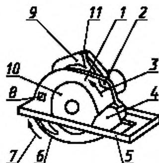
1—10 (см. рисунок 101); 11 — рычаг разблокирования фиксации защитного кожуха тянущегося типа
