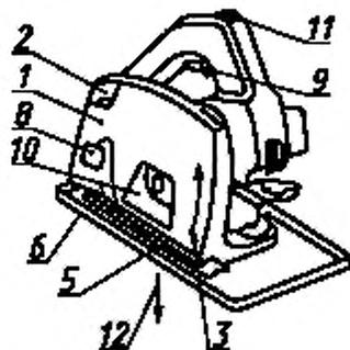
1—3; 5; 6; 8—10 (см. рисунок 101); 11 — рычаг разблокирования фиксации погружения; 12 — направление погружения пильного диска
