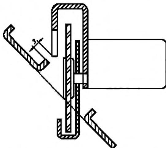
Рисунок 107 — Дисковая пила с наклонно устанавливаемой направляющей плитой
