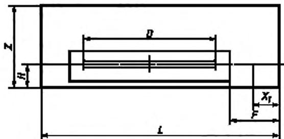
$D$  – диаметр пильного диска;  $L$  – длина направляющей плиты;  $Z$  – ширина направляющей плиты;  $H$  – расстояние плоскости пильного диска от края направляющей плиты;  $F$  – расстояние между проемом в направляющей плите и передним краем направляющей плиты;  $X_1$  – длина проема в направляющей плите
