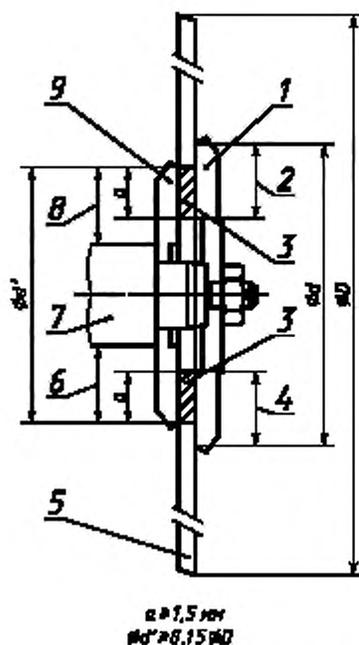
1 – наружный фланец; 2, 4 – контактная поверхность; 3 – перекрываемая поверхность;
