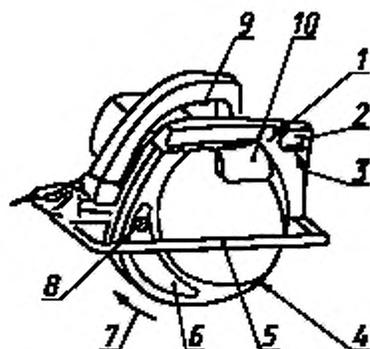
1 — неподвижный защитный кожух; 2 — отверстие для выброса опилок; 3 — указание направления вращения пильного диска, 4 — подвижный защитный кожух; 5 — направляющая плита; 6 — расклинивающий нож; 7 — направление открытия подвижного защитного кожуха; 8 — устройство крепления расклинивающего ножа; 9 — выключатель; 10 — пильный диск
