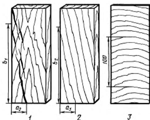
1 — тангентальный наклон волокон в пилопродукции и шпоне ( $\alpha_1 = \frac{a_2}{b_1}$ );
