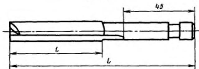
Вариант изготовления фрез типа 2 с винтовой канавкой
