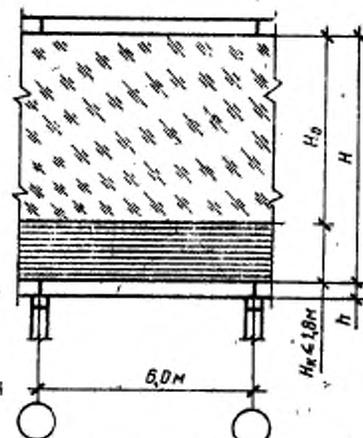
$H$  — полная высота слоя кладки над балкой;  $H_0$  — высота слоя кладки над балкой до проема;  $H_1, H_2, \dots, H_n$  — полная высота проемов в пределах высоты слоя кладки  $H$ ;  $h_1, h_2, \dots, h_n$  — высоты проемов, расположенных в пределах высоты слоя кладки  $H$
