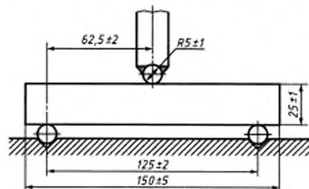
на обеспечивать равномерную нагрузку на середину образца по всей его ширине и возможность увеличения нагрузки с постоянной скоростью так, чтобы напряжение в образце увеличивалось со скоростью  $(0,15 \pm 0,015)$  Н/мм<sup>2</sup> · с<sup>-1</sup>. Погрешность измерения изгибающей силы в момент разрушения образца должна быть не более  $\pm 2$  %.
