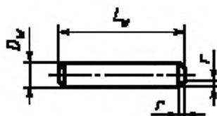
$D_w$  — номинальный диаметр ролика;  $L_w$  — номинальная длина ролика;  $R$  — номинальный радиус сферы торца ролика;  $r$  — номинальная координата фаски ролика с плоским торцом.
