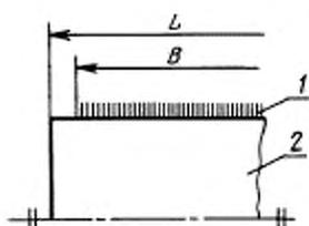
1 — расчесывающая гарнитура; 2 — главный барабан;  $L=B+(0 \dots 50)$ , мм, где  $L$  — длина главного барабана.
