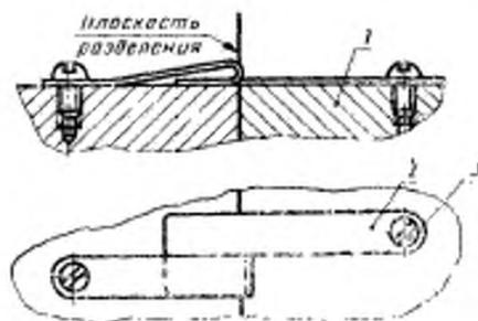
1 — отсек; 2 — разрывная перемычка; 3 — винт типа М по ГОСТ 18707
