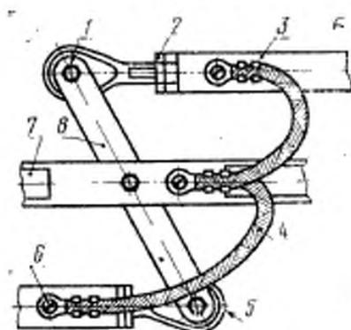
1 — болт, 2 — гайка; 3 — шайба; 4 — перемычка типа Д; 5 — болт ушкообразный; 6 — винт; 7 — балка; 8 — кронштейн
