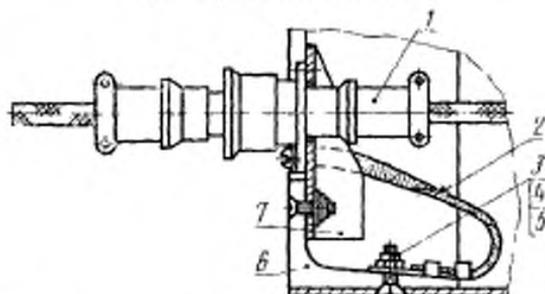
1 — электрический соединитель; 2 — неразъемная перемычка типа А по ГОСТ 18707; 3 — винт; 4 — гайка; 5 — шайба; 6 — шлангоут; 7 — кронштейн
