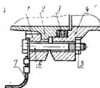
1 — накладной фланец трубопровода; 2 — трубопровод; 3 — прокладка; 4 — фланец; 5 — гайка; 6 — болт; 7 — неразъемная перемычка типа А по ГОСТ 18707
