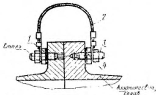
1 — гайка; 2 — неразъемная перемычка; 3 — шпилька; 4 — токопроводящая шайба
