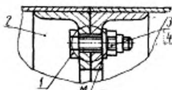
М — место металлизации; 1 — болт; 2 — проставка; 3 — гайка; 4 — шайба
