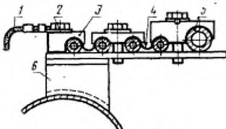
1 — неразъемная перемычка типа А по ГОСТ 18707—81; 2 — болт; 3 — колодка; 4 — алюминиевая фольга; 5 — трубопровод; 6 — кронштейн
