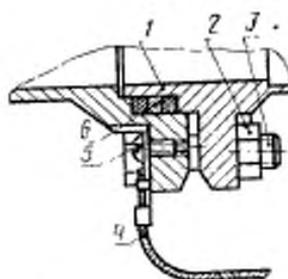
1 — фланец трубопровода; 2 — гайка; 3 — болт; 4 — неразъемная перемычка типа А по ГОСТ 18707; 5 — винт; 6 — прокладка
