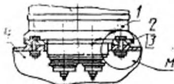
М — место металлизации; 1 — прибор; 2 — болт; 3 — гайка; 4 — кронштейн
