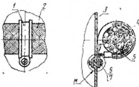
M — место металлизации; 1 — хомут зажимной с обкладкой; 2 — экран жгута; 3 — кронштейн; 4 — жгут; 5 — медная лента; 6 — винт; 7 — гайка
