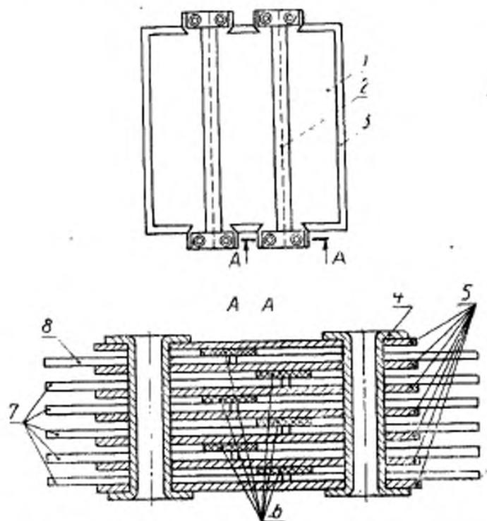
1 — мат ЭВТИ; 2 — сварной шов полотен наружного экрана мата ЭВТИ; 3 — окантовка мата ЭВТИ; 4 — пикет, 5 — металлическая фольга, 6 — сварной шов; 7 — пленка металлизированная; 8 — наружная пленка мата ЭВТИ
