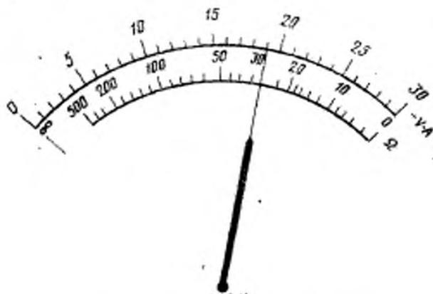
Изменяя сопротивление магазина, устанавливают последовательно стрелку прибора на отметки 19 и 20 равномерной шкалы. При этом получены значения сопротивления 32,3 и 28,0 Ом.
