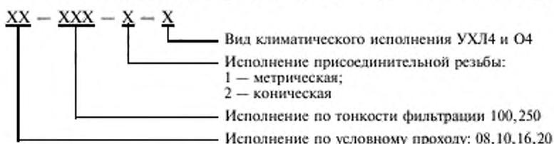
Пример условного обозначения фильтра с условным проходом 10 мм, тонкостью фильтрации 100 мкм, с метрической присоединительной резьбой, предназначенного для стран с умеренным и холодным климатом, категории размещения 4:
