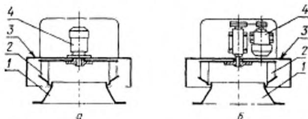
1 - входной патрубок; 2 - рабочее колесо; 3 - корпус; 4 - электродвигатель
