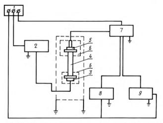
I— стабилизированный источник питания;2— генератор ультразвуковых колебаний; 3— датчик (пьезоэлемент); 4— образец; 5— приемник (пьезоэлемент); 6— экран;7— усилитель; 8— осциллограф; 9— частотомер
