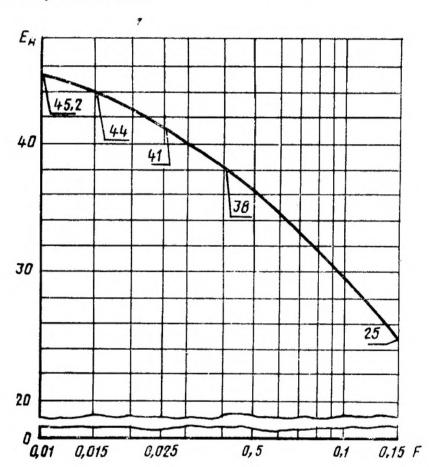
$E_{\rm H}$  — напряженность поля радиопомех, дБ; F — частота,  $M\Gamma_{\rm H}$
