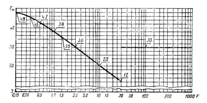
$E_{_{\rm II}}$  — напряженность поля радиопомех, дБ; F — частота, МГц Примечание. На частоте 30 МГц нормой считается 12 дБ.
