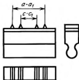
$c$  и  $c_1$  — метки для измерения удлинения образца;
