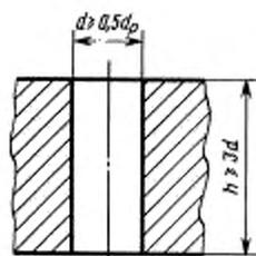
$d_p$  — наибольший диаметр растачиваемого отверстия на станке.
