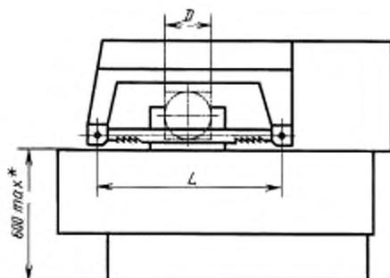
\* Расстояние от низа основания станка до опорной поверхности заготовки.
