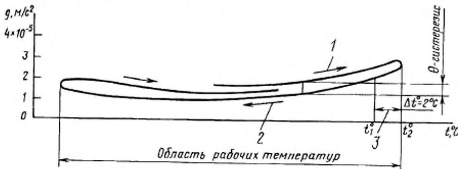
1 — прямой ход; 2 — обратный ход; 3 — участок для определения модуля экстремального температурного коэффициента
