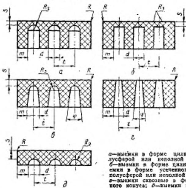
а—выемки в форме цилиндра с полусферой или неполной полусферой; б—выемки в форме цилиндра; в—выемки в форме усеченного конуса с полусферой или неполной полусферой; г—выемки сквозные в форме усеченного конуса; д—выемки в форме полусферы и неполной сферы.
