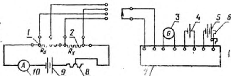
1—набор образцовых сопротивлений класса 0,01 (эталонных); 2—исследуемое сопротивление; 3—вольтметр чувствительностью порядка  $1 \cdot 10^{-9}$  А/дел.; 4—порочный элемент Вестона; 5—источник постоянного тока; 6—реостат; 7—потенциометр постоянного тока или мост Томсона; 8—реостат; 9—источник постоянного тока; 10—амперметр постоянного тока класса 0,5.
