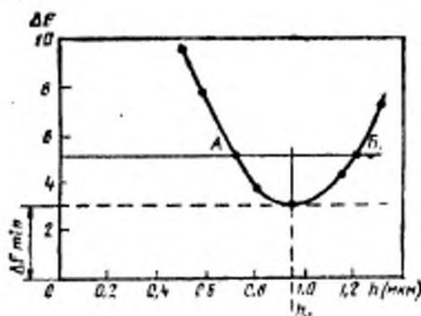
$\Delta E_{\min}$  — минимальное цветовое различие;  $h_0$  — оптимальная толщина красочного слоя, соответствующая минимальному цветовому различию, мкм
