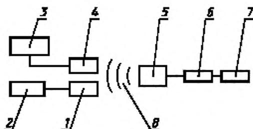
1 — измерительный микрофон; 2 — шумомер; 3 — прибор — регистратор извещений; 4 — извещатель; 5 — излучатель; 6 — усилитель мощности; 7 — источник сигнала; 8 — акустический канал
