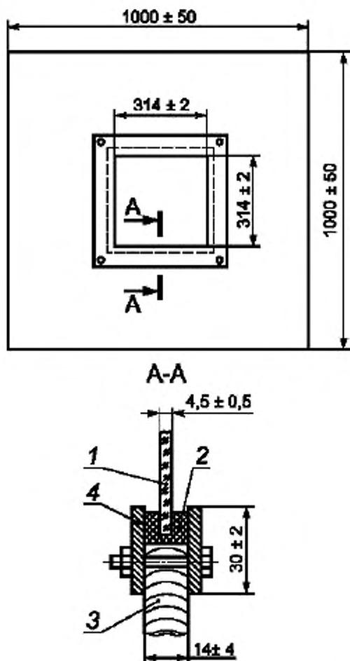
1 — стеклянный лист; 2 — резиновая прокладка; 3 — древесно-стружечная плита или фанера площадью  $1 \text{ м}^2$ ; 4 — монтажные рамы
