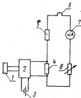
1, 5—стабилизатор напряжения П-30-1; 2—потенциометр Р363-2; 3—нормальный элемент Нз 65; 4—образцовая катушка сопротивления, 10 Ом; 5—нагреватель калориметра; 7—миллиамперметр 0—50 мА; 8—магazine сопротивления Р33
