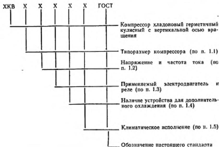
Пример условного обозначения компрессора типоразмера 5, для сети напряжением 220 В и частотой тока 50 Гц, с электродвигателем ЭД и пускозащитным реле типа Р, без дополнительного охлаждения, климатического исполнения УХЛ:
