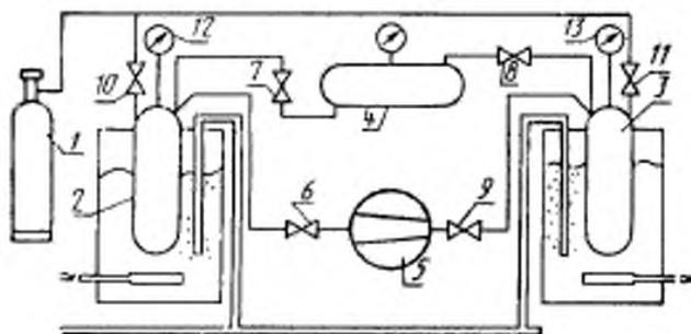
1—баллон для хладона; 2—сосуд высокого давления (сторона всасывания); 3—сосуд высокого давления (сторона нагнетания); 4—промежуточный сосуд; 5—компрессор; 6—11—запорные клапаны; 12—манометр для стороны всасывания; 13—манометр для стороны нагнетания
