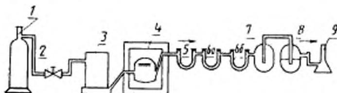
1—баллон для азота; 2—регулирующий вентиль; 3—сушильная башня; 4—нагревательная камера с компрессором; 5—U-образная трубка с притертой пробкой и наполненная стеклянной ватой, вбб—U-образные трубки с притертой пробкой, наполненные  $P_2O_5$  и немзой; 7—отметчик пузырьков без амальгамы; 8—отметчик, заполненный  $H_2SO_4$ ; 9—расходомер
