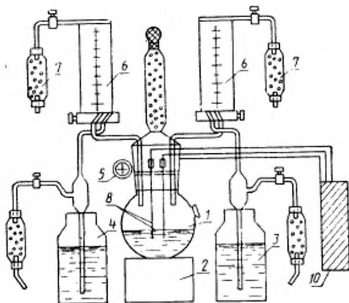
1—титровальная колба; 2—магнитная мешалка; 3—колба с реагентом Карла-Фишера; 4—колба со спиртом; 5—электродный индикатор; 6—бюретки; 7—трубки, наполненные сульфатом; 8—платиновые электроды; 9—провод; 10—система показания электрического титрования
