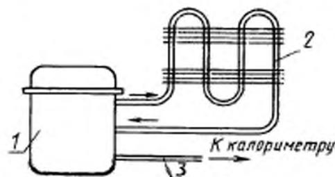
1—компрессор; 2—конденсатор; 3—патрубки охлаждения компрессора
