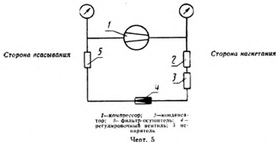
При испытании в конкретном холодильном агрегате допускаются другие значения давления на стороне всасывания и нагнетания.
