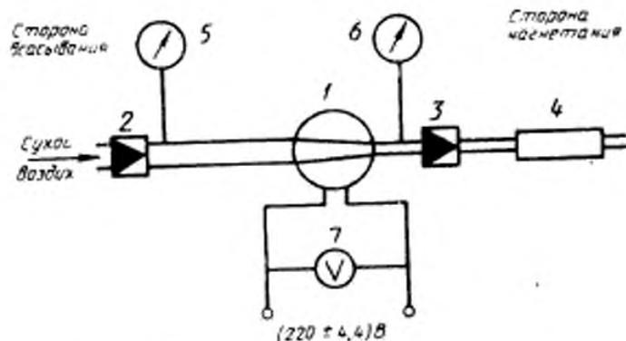
1—компрессор; 2, 3—регулирующие вентили; 4—расходомер; 5, 6—манометры; 7—вольтметр
