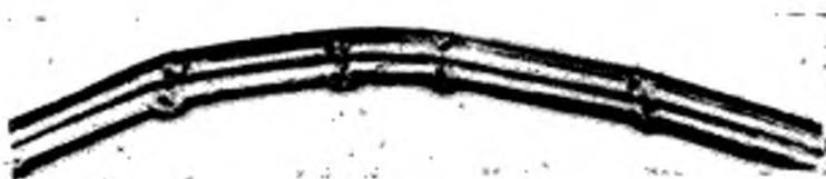
Волокно цилиндрическое с хорошо заметными поперечными линиями (трещинами). Толстые стенки волокна окружают равномерную узкую (не шире толщины стенки) ясно очерченную полость
