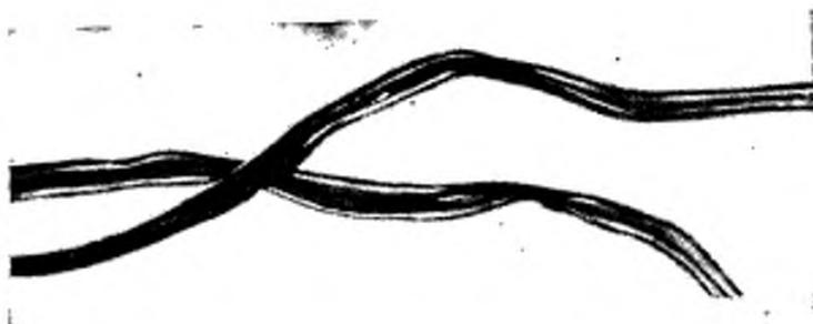
Волокна лентообразной формы, тонкостенные, скрученные вокруг своей продольной оси спирально
