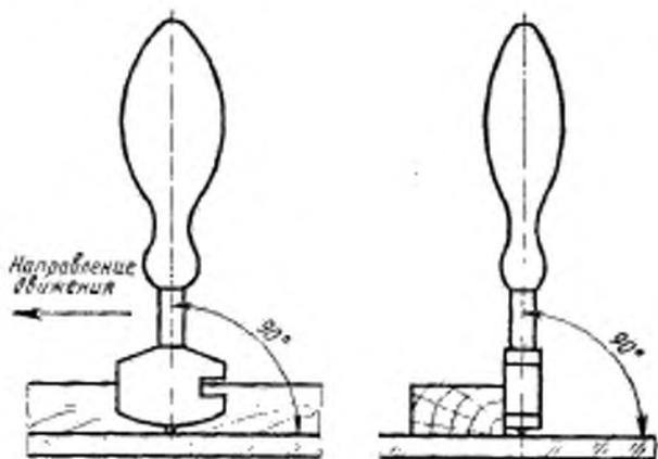
г) наклон стеклореза к плоскости стекла определять путем пробных резов.
