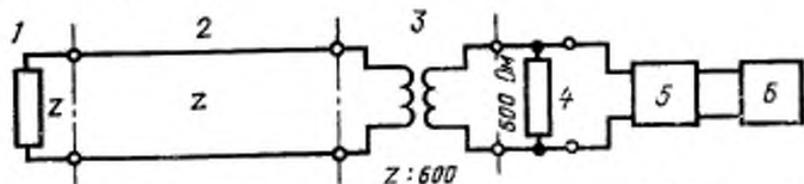
1 — сторона, противоположная месту измерения; 2 — линия связи с волновым сопротивлением  $Z$ ; 3 — согласующий трансформатор; 4 — сопротивление нагрузки 600 Ом; 5 — псофометр; 6 — самопишущий измерительный прибор
