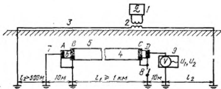
1 — генератор; 2 — согласующий трансформатор; 3 — цепь питания; 4 — кабель связи; 5 — бреша; 6 — оболочка; 7 — жила; 8 — выключатель; 9 — селективный вольтметр;  $l_1$  — длина измерительного участка;  $l_2$  — участка между концами измерительного участка и концами искусственной влияющей цепи. А, В, С, D — кольцевые электроды, которые припаяны к оболочке и бреша
