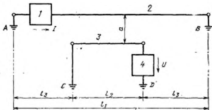
1 — генератор тока; 2 — развернутая линия питания длиной  $l_1$ ; 3 — развернутая измерительная цепь длиной  $l_4$ ; 4 — селективный вольтметр; A, B — конечные точки цепи питания; C, D — конечные точки измерительной цепи; a — расстояние между цепью питания и измерительной линией;  $l_2$  — расстояние между A и C или соответственно между D и B;  $2000 \text{ м} < l_1 < 3000 \text{ м}$ ;  $20 \text{ м} < l_2 < 60 \text{ м}$ ;  $50 \text{ м} < a < 300 \text{ м}$
