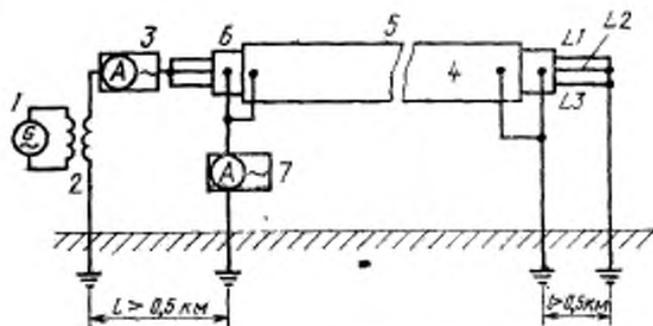
1 — генератор; 2 — согласующий трансформатор; 3 — устройство для измерения величины тока в жилах кабеля; 4 — силовоточный кабель; 5 — броня; 6 — оболочка; 7 — устройство для измерения величины тока в оболочке и в броне; L<sub>1</sub>, L<sub>2</sub>, L<sub>3</sub> — жила силовоточного кабеля; l — расстояние между устройствами заземления
