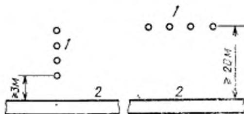
1 — стержни заземления; 2 — металлическое сооружение, проложенное в земле
