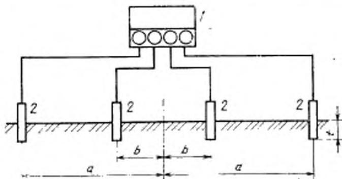
1 — измеритель сопротивления заземления; 2 — стержни заземления (измерительные электроды);  $0,1 \text{ м} \leq l \leq 0,15 \text{ м}$ ;  $1,5 \text{ м} \leq a \leq 20 \text{ м}$ ;  $0,5 \text{ м} \leq b \leq 3 \text{ м}$
