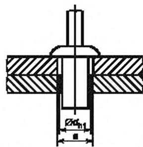
Рисунок 2 — Увеличенный диаметр отверстий для облегчения совмещения
