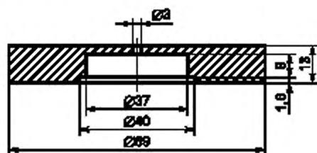
Материал конструкции: Monolux 500 (термостойкие картоны) или его эквивалент
