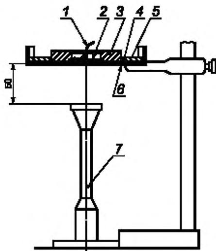
1 — провода термпары; 2 — калориметр; 3 — монтажный блок калориметра; 4 — установочная пластина калориметра; 5 — образец; 6 — опорная рама для образца; 7 — газовая горелка
