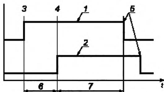
1 — первая рука оператора; 2 — вторая рука оператора; 3 — начало первого входного сигнала; 4 — начало второго входного сигнала; 5 — окончание входных сигналов; 6 — запаздывание по времени не определено, одновременное приведение в действие; 7 — интервал времени при одновременном приведении в действие
