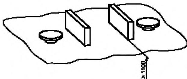
Рисунок А.11 — Предотвращение возможности обхода местом установки
