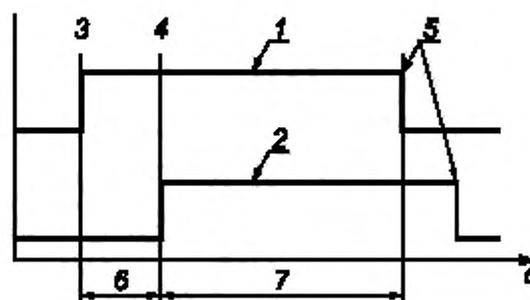
1 — первая рука; 2 — вторая рука; 3 — начало первого входного сигнала; 4 — начало второго входного сигнала; 5 — окончание входных сигналов; 6 — запаздывание по времени ( $t \leq 0,5$  с), синхронное приведение в действие; 7 — интервал времени при синхронном приведении в действие
