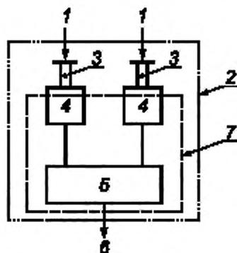
1 — входной сигнал; 2 — двуручное устройство управления; 3 — исполнительное устройство управления;
