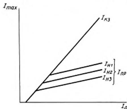
$I_{н1}, I_{н2}, I_{н3}$  — номинальные токи предохранителя;  $I_{пр}$  — пропускаемый ток предохранителя;  $I_{кз}$  — ток асимметричного короткого замыкания;  $I_{max}$  — максимальное значение тока;  $I_0$  — ток отключения
