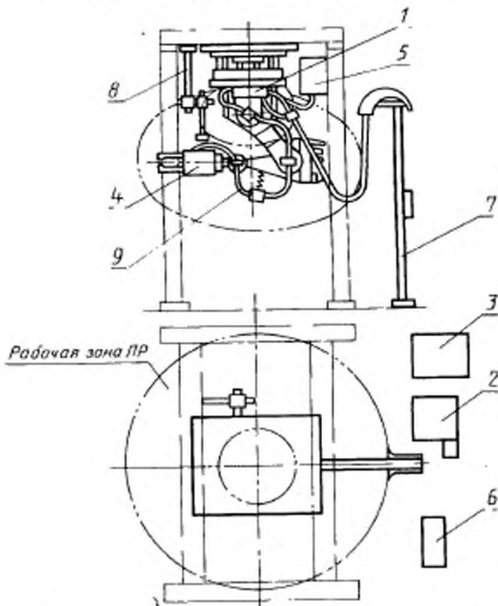
1—исполнительное устройство ПР; 2—устройство управления ПР; 3—силовой шкаф ПР; 4—сварочный инструмент; 5—источник сварочного тока; 6—система управления сварочным током; 7—панель энергоснабжения; 8—стойка исходного положения; 9—система энергоподвода.
