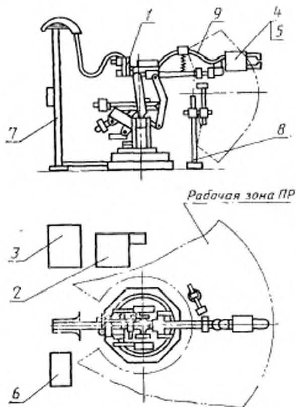
1—исполнительное устройство ПР; 2—устройство управления ПР; 3—силовой шкаф ПР; 4—сварочный инструмент; 5—источник сварочного тока; 6—система управления сварочным током; 7—платье амортизации; 8—стойка исходного положения; 9—система электроподвода
