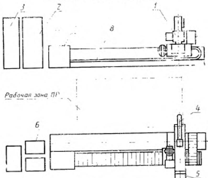
1—исполнительное устройство ПР; 2—устройство управления ПР; 3—силовой шкаф ПР; 4—сварочный инструмент; 5—источник сварочного тока; 6—система управления сварочным током; 7—панель энергоснабжения; 8—система энергоподвода.
