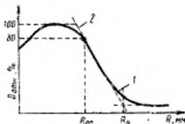
$D_{отн}$  — относительная поглощенная доза или относительный ионизационный ток;  $R$  — глубина в водном фантоме; 1 — кривая осевой относительной глубинной дозы или ионизации; 2 — касательная в точке перегиба.
